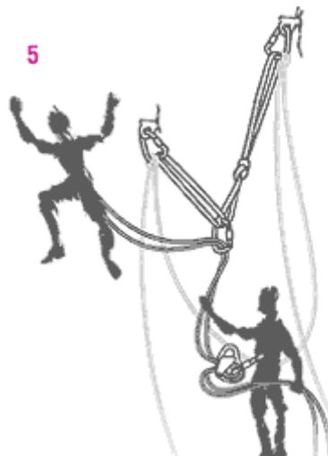
**5** Le second devient alors leader. Il mousquetonne ses brins dans un point de renvoi. Pour cela, il utilise le mousqueton en milieu de sangle, afin de répartir la force de choc de manière égale sur les deux points du relais. La plupart des systèmes d'assurage nécessitent un point de renvoi pour éviter qu'en cas de chute l'assureur ne se brûle pas les mains en retenant la corde.
